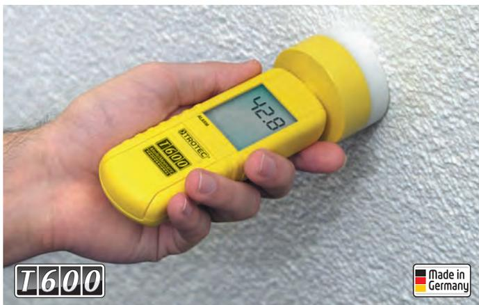
Il modello T600 è un dispositivo di misurazione manuale di produzione e qualità tedesca per il rilevamento rapido e non distruttivo dell'umidità in profondità.
