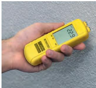
Infatti, proprio per il rilevamento dell'umidità di materiali lignei, il dispositivo T500 dispone di un'opzione del menu che consente di scegliere tra cento diverse tipologie di legno.
