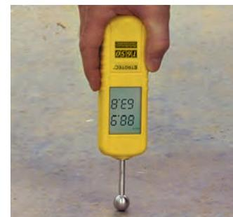
Grazie alla visualizzazione permanente in tempo reale dei valori misurati sul display di facile lettura, è possibile individuare rapidamente superfici di pavimenti o pareti umide o asciutte. Inoltre il dispositivo di misurazione è ideale per l'esame preliminare della maturità tecnica di materiali da costruzione durante le misurazioni CM.
