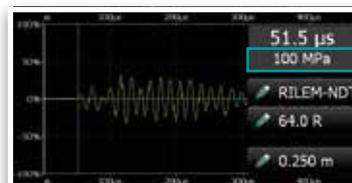
La resistenza alla compressione è calcolata mediante correlazione con la sola velocità di propagazione ovvero tramite il metodo combinato SONREB.
