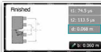
Determina la profondità delle fessure perpendicolari alla superficie in conformità allo standard BS 1881.
