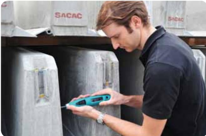
**ST/PC tipo N/L:** lo sclerometro più avanzato al mondo con caratteristiche di dispersione, durezza e range di misurazione ineguagliabili.
