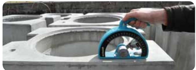
**Tipo PT:** equipaggiato con un pistone di grandi dimensioni è particolarmente adatto per la prova di materiali più teneri quali il calcestruzzo leggero, le lastre di gesso e il cemento fresco. È sovente utilizzato per determinare quando togliere le casseforme dalla volta di una galleria.
