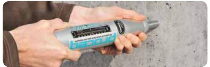
**Tipo N/L:** il punto di riferimento per tutti gli sclerometri per calcestruzzo e la base per la determinazione degli standard internazionali in questo ambito. Disponibile con energie di impatto differenti per consentire al cliente di provare materiali e tipi di strutture diversi.
