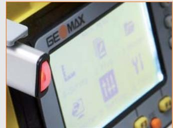
La porta USB è fornita come standard con tutti gli strumenti della Serie Zoom30, quindi è possibile trasferire i dati da uno strumento all'altro, sul pc e su altri device con una normale chiavetta USB o con la super performante chiavetta GeoMax ZMS100
